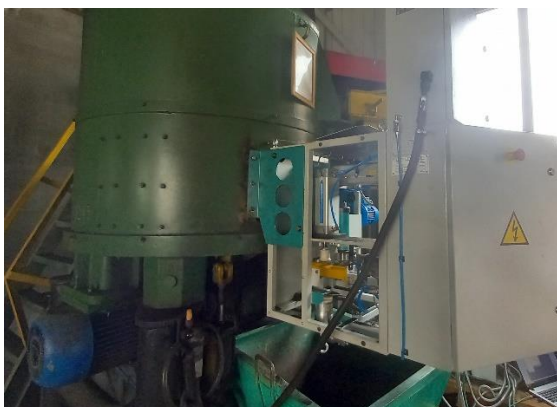
Рис. 2 Настройка и испытания устройства на вихревом смесителе в ОАО «БЕЛНИИЛИТ»
